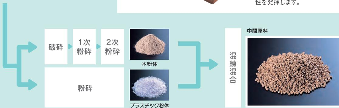
集められた原材料をチェックしたのち、破碎された廃木材は1次粉碎・2次粉碎して数100ミクロンの微粉体に、廃プラスチックは10mm以下に粉体として配合工程へ送りこみます。
