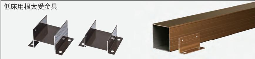
束金物を使用できない低床納まりの場合に使用する専用金具で最小75mmまで対応可能です。（アルミ根太35×65と低床用根太受金10を使用した場合）
