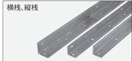
テクモクルーバー材を取付ける部材です。必要強度、納まり寸法、用途などにより3種類からお選びいただけます。横棧、縦棧は強度に優れたスチール製で切断、穴明けなどの加工後溶融亜鉛めっき処理を施し、高い防錆性能を確保。ご要望に応じ塗装仕様にも対応いたします。
