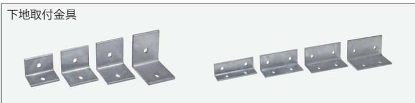
横棧、縦棧を躯体に取付けるために仕様する部材です。必要強度、納まり寸法、用途などにより4種類からお選びいただけます。強度に優れたスチール製で切断、穴明けなどの加工後溶融亜鉛めっき処理を施し、高い防錆性能を確保。ご要望に応じ塗装仕様にも対応いたします。
