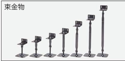
7種類の束金物を用意。デッキ高さに応じて最適なものをお選びいただけます。束金物は強度に優れたスチール製で高い防錆性能を持つ溶融亜鉛めっき処理に化粧塗装を施しています。
